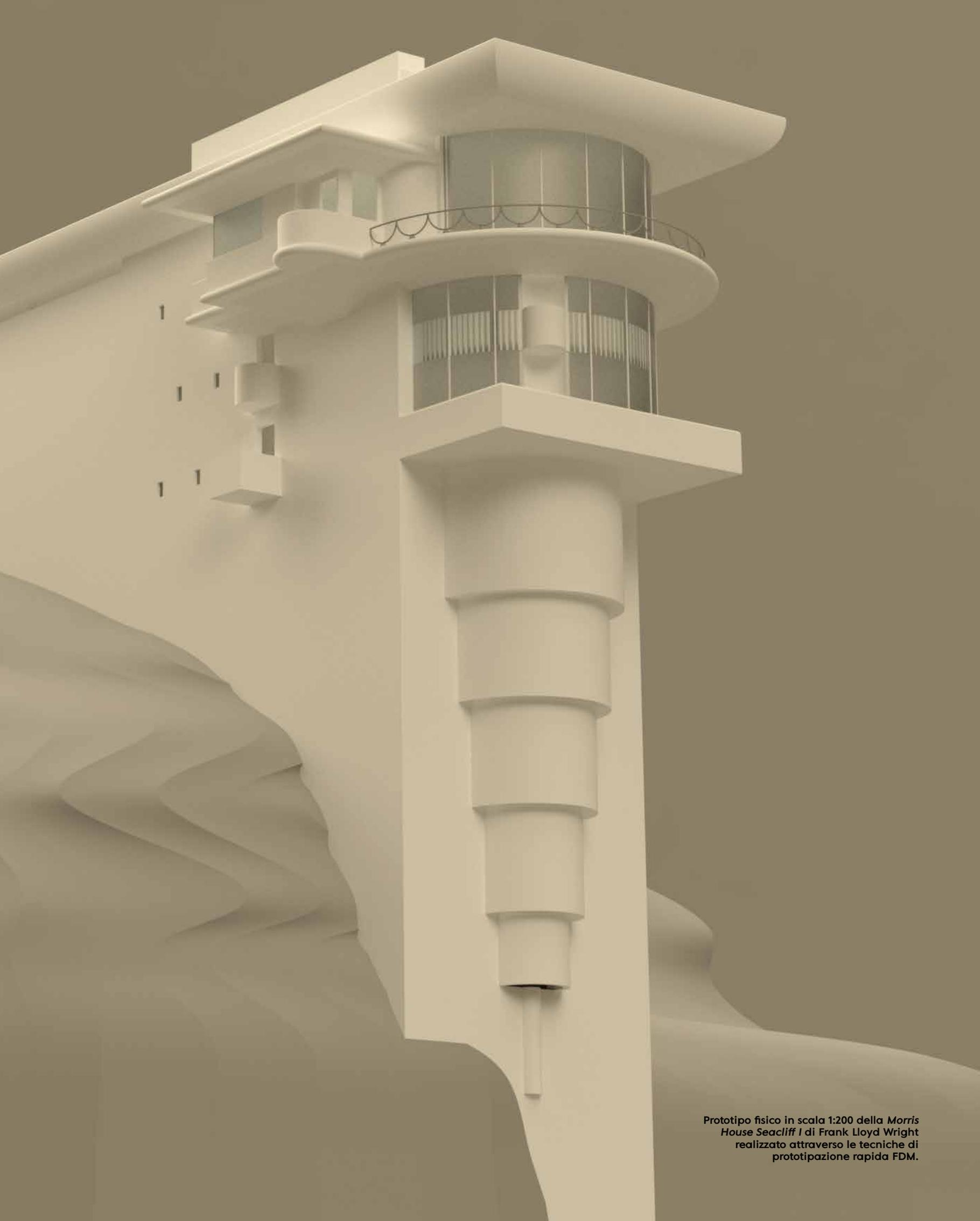
Prototipo fisico in scala 1:200 della *Morris House Seacliff I* di Frank Lloyd Wright realizzato attraverso le tecniche di prototipazione rapida FDM.
